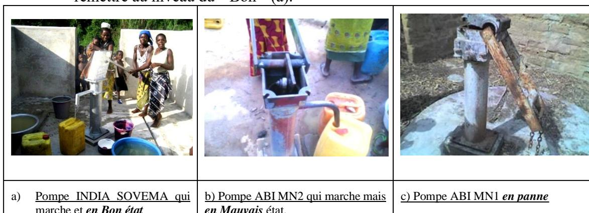
**Figure 3.15 Types d'Etats de Fonctionnement de PMH**
